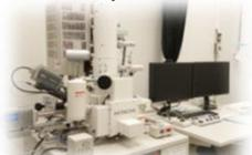
[装置の例] 高分解能走査電子顕微鏡
