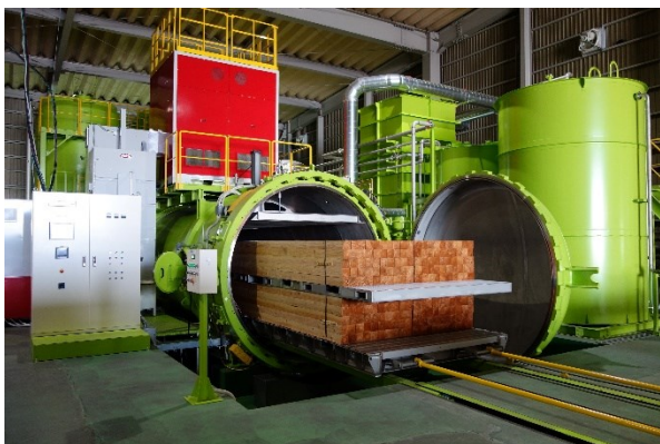
防腐剤注入処理
