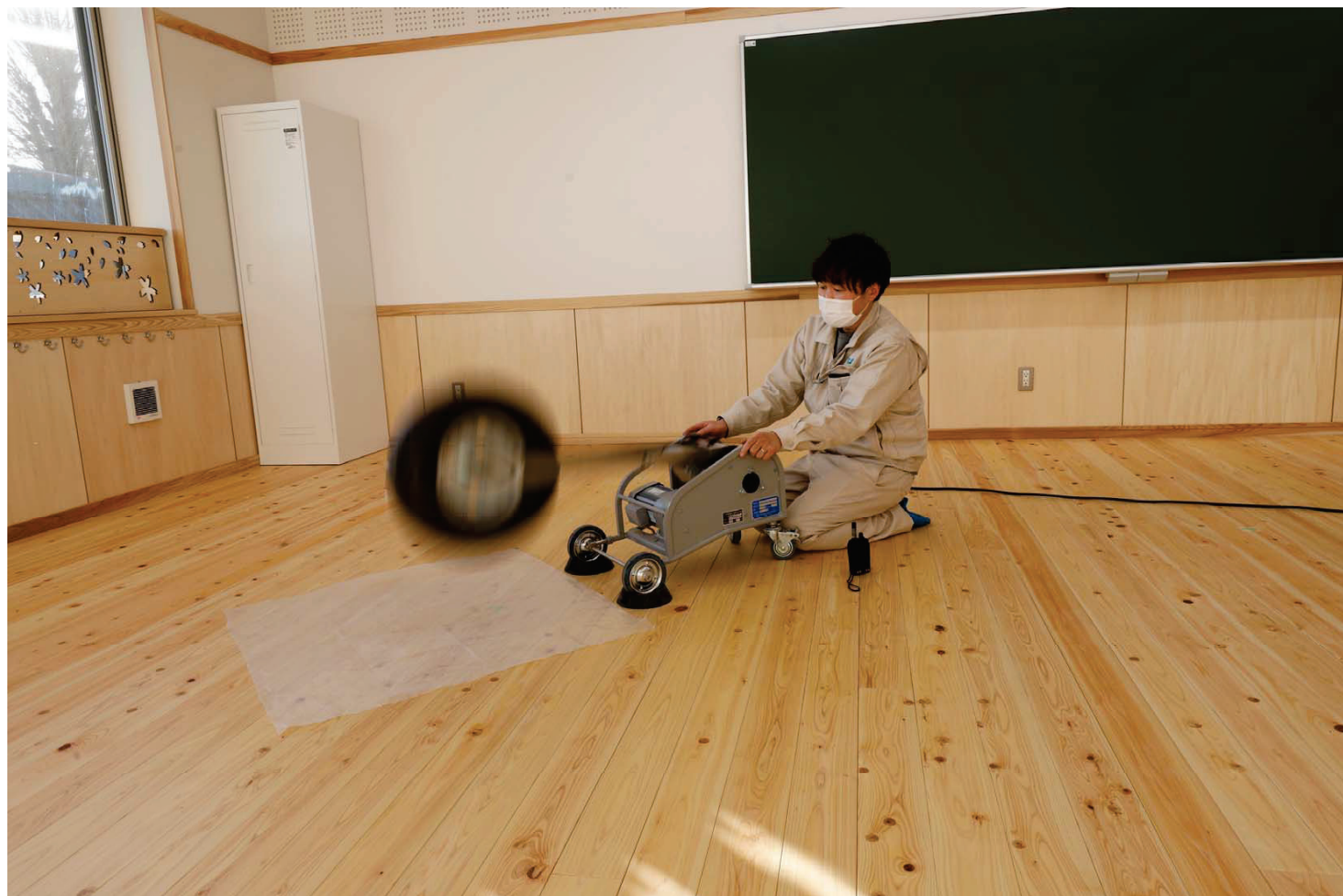
校舎西棟 床遮音性能測定(完成時) 令和3年1月18日
